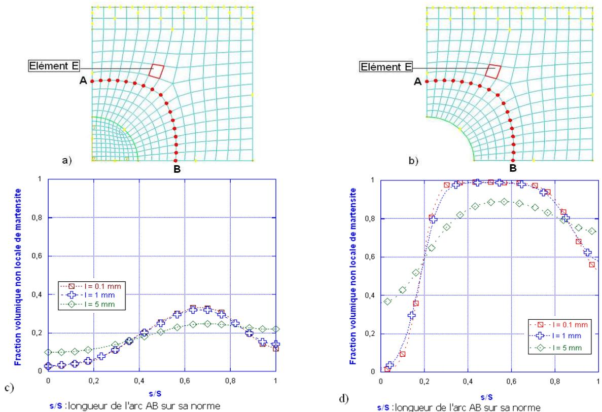
Fig. 3. Evolution de la fraction volumique non-locale de martensite pour les deux plaques suivant le chemin AB à la température  $T = 5^{\circ}\text{C}$  pour différentes valeurs du paramètre de longueur interne  $l$
